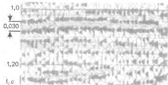
Рис. 2. Фрагмент сейсмічного запису часового розрізу
