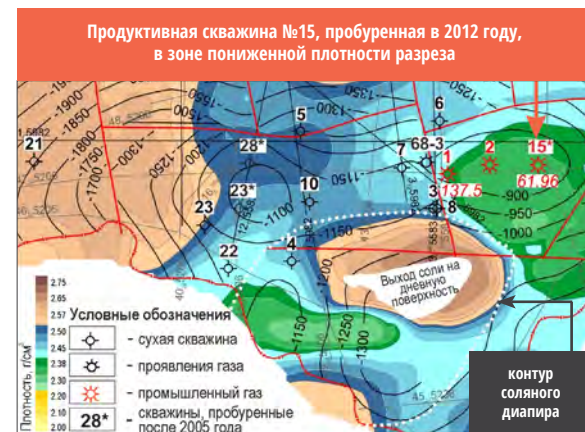
Рисунок 11. Контур неогенового газонасыщенного резервуара Солотвинского газового месторождения по значению плотности 2,38 г/см³. Продуктивная скважина №15 раскрывает разуплотненный газонасыщенный разрез
