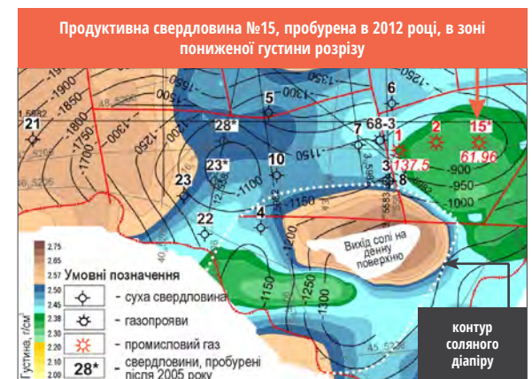
Рисунок 11. Контур неогенового газонасиченого резервуару Солотвинського газового родовища по значенню густини 2,38 г/см³. Продуктивна свердловина №15 розкриває розуцільнений газонасичений розріз
